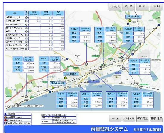
雨量監視システム
