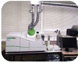
誘導結合プラズマ質量分析装置 水道水中の金属成分を測定します。
