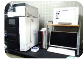
高速液体クロマトグラフ分析装置 洗剤（界面活性剤）成分を測定します。
