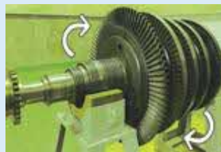
※ タービン(羽根車) 中心の回転する丸いぼう(じく)のまわりに、羽根がついています。
