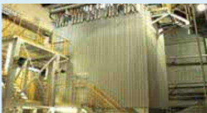
⑦ ろ過式集じん器 排ガスにふくまれるちりや、有害物を取りのぞきます。
