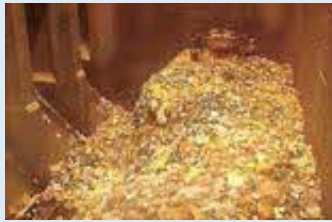
② ごみピット/ごみクレーン ごみピットにたまったごみは、クレーンでつかみ、 しょうきゃくろ 焼却炉に入れます。
