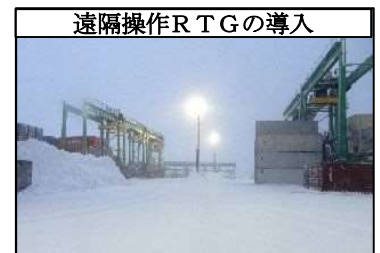
遠隔操作RTGの導入 荷役作業効率の向上や港湾労働者不足への対応が期待されるが、積雪寒冷地仕様が課題
