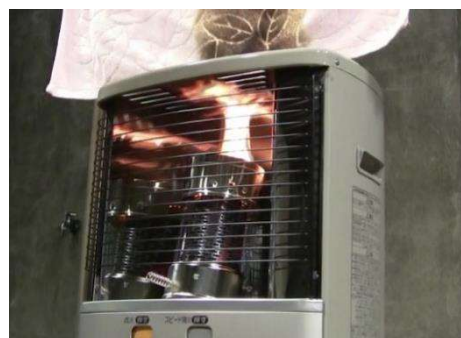
燃焼筒のずれによる異常燃焼
