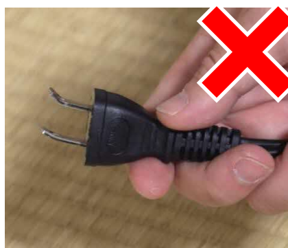
変形した電源プラグは使用しない
