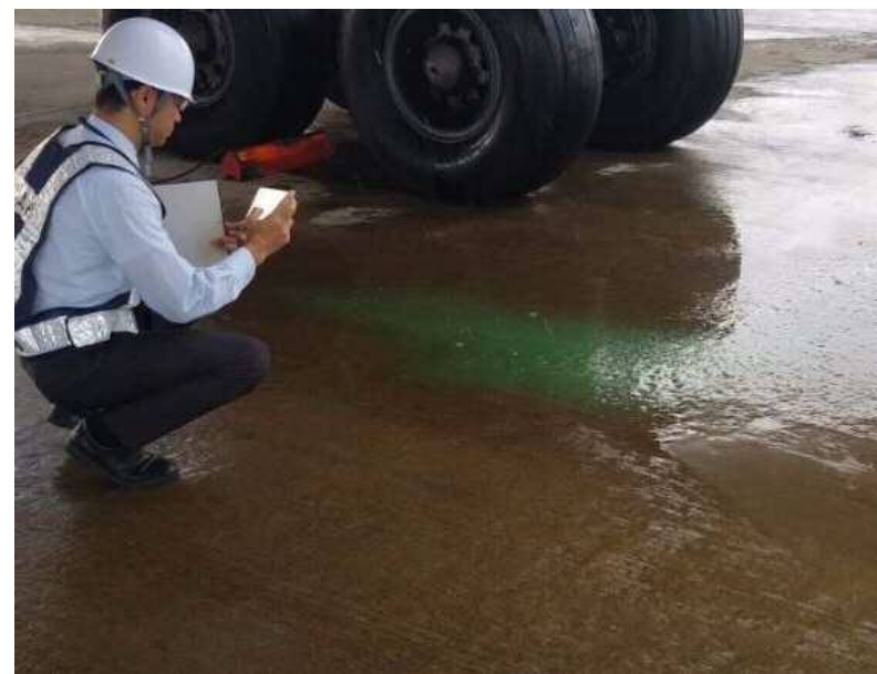
(b) Type IV散布後の路面の様子
