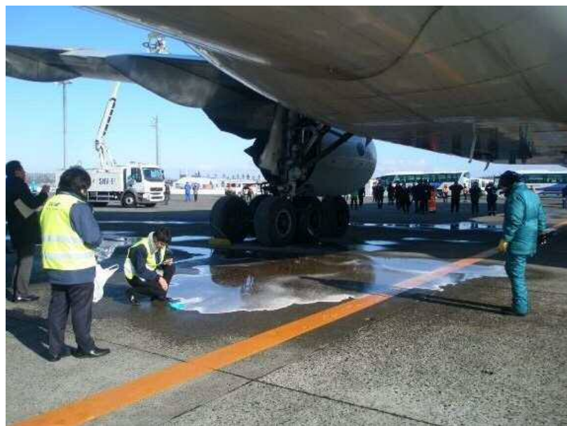
(a) Type I散布後の路面の様子
