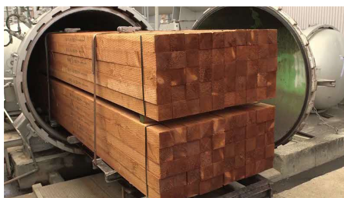
写真 1.3.1 薬剤を加圧処理する注薬缶
