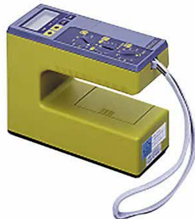
写真 2.2.3 高周波誘電率式水分計 (例)
