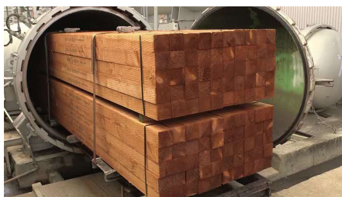
写真 1.3.1 薬剤を加圧処理する注薬缶
