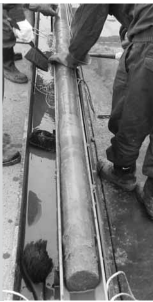
地下から採取した地質サンプル。貯留に適した萌別層と滝ノ上層を確認（H23（2011）年2月）
